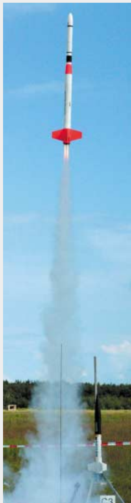
Eine Nike-Rakete von Peter Gisder aus Bindlach. Das 1,50 Meter große Modell wird von vier gebündelten Schwarzpulver-Treibsätzen angetrieben und erreicht innerhalb von fünf Sekunden eine Höhe von gut 300 Metern.
